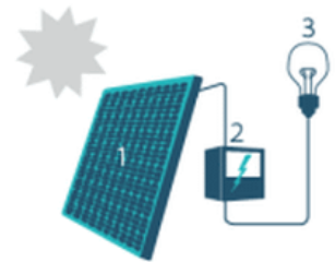
1. Zonnepaneel | 2. Omvormer | 3. Elektrische toestellen
